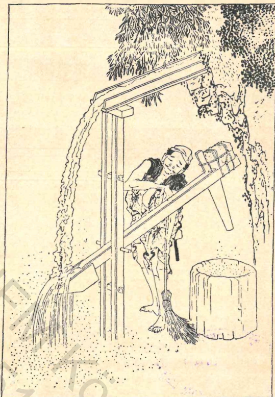
Abb. 18. Reiskampfer, der den Mädel durch Wasserdruck in Betrieb setzt.
